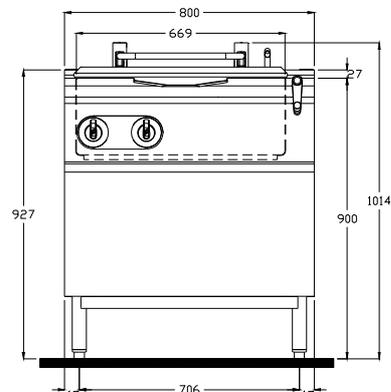
La manœuvre de la poignée engendre un volume qui déborde du côté extérieur droit. Pour une ergonomie correcte, il est nécessaire d'avoir un minimum de 170mm de dégagement. En conséquence, il n'est pas possible de placer une sauteuse à **basculement manuel** à moins de 170mm d'une paroi.
